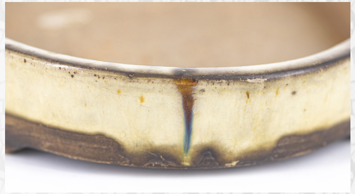
Detalle de gota por contaminación dentro del horno.
